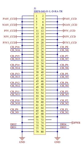
Figure 24 : LVDS Module Connector
